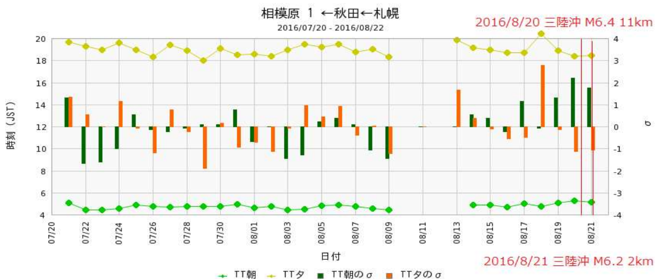
Fig. 6 札幌→相模原観測点間パスにおける AM 放送波活用電離層擾乱観測 Monthly データ
